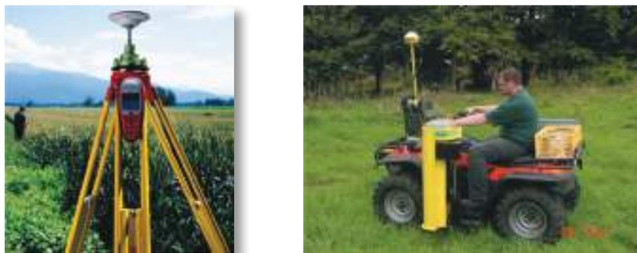
*Figura 6 – Teodolito e moto-quatro adaptada para recolha de amostras de solo georreferenciadas, respetivamente. (Fonte: <http://www.irishscientist.i>)*
